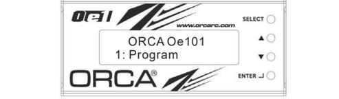
"▲" ボタンと、"▼" ボタンを使用し[Program], [Update] or [Data Record]を選択し、"ENTER"ボタンを押し、項目を入力します。各項目は、独立したプログラミングとなりました。各項目毎に設定を行って下さい。"SELECT"ボタンを2秒間押しず、前の項目へ戻る事が出ます。
